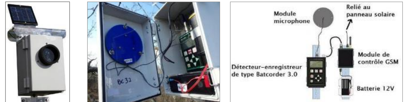
Figure 74 : Boîtier d'enregistrement autonome et montage (Source : EcoObs, AXECO)
