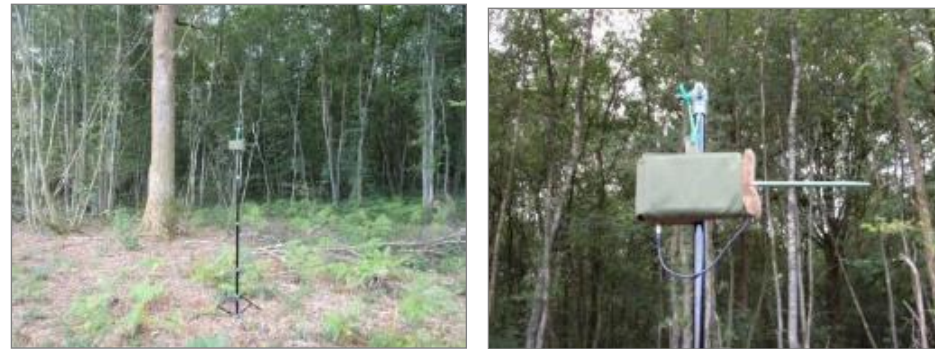
Figure 69 : Batcorder posé en point d'écoute fixe long (Source : AXECO)
